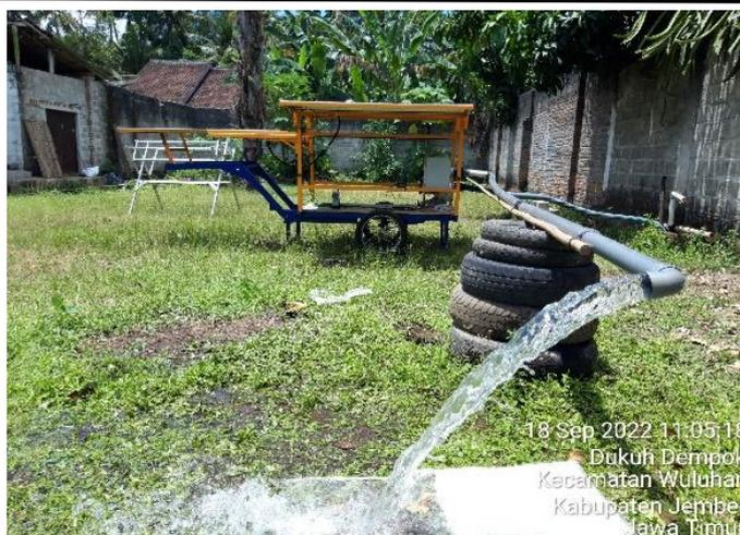
**Gambar 6.** Pengujian Debit Pompa Irigasi Bertenaga Surya
