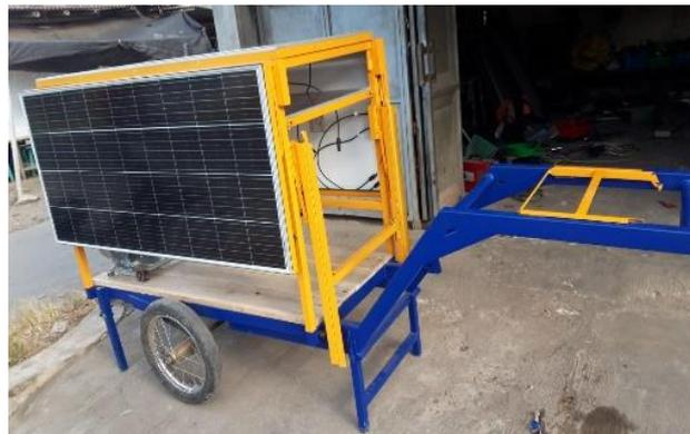
**Gambar 3.** Rangkaian Alat Pompa Irigasi Bertenaga Surya
