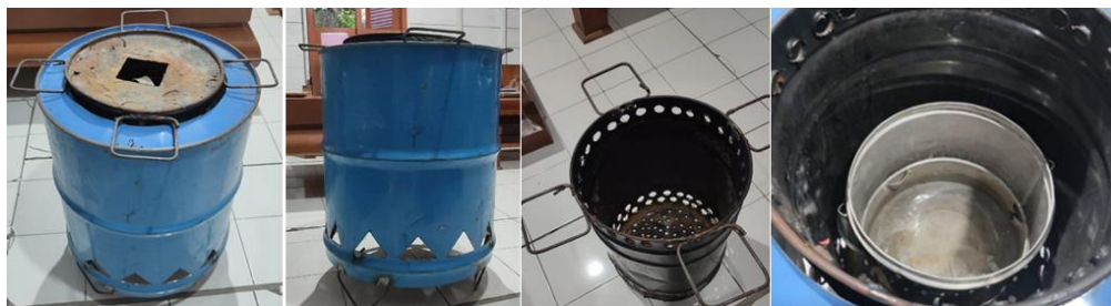
Gambar 5. Kompor pengarang yang telah didesain dan dibuat oleh tim pengabdian (dari kiri ke kanan): a. tampak tabung luar dan tabung tengah; b. tampak dinding tabung luar; c. tampak tabung Tengah; d. tampak tabung luar, tengah dan dalam
