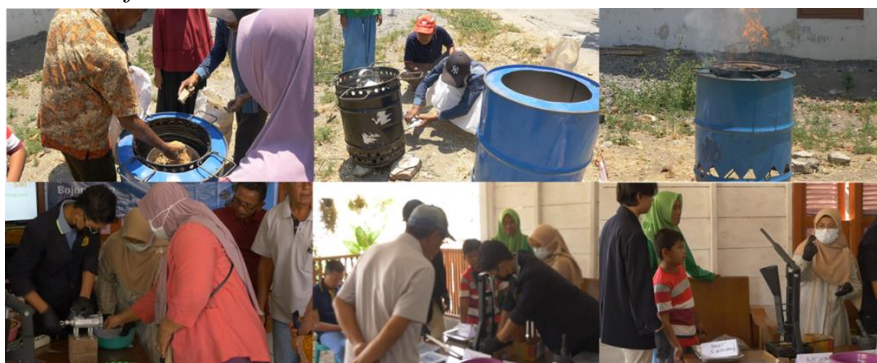
Gambar 9. Kolase dokumentasi kegiatan praktek pembuatan arang briket; baris ke 1 (dari kiri ke kanan): Peserta pelatihan memasukkan bahan baku ke dalam kompor pengarang, peserta menyalakan kompor pengarang, pembakaran fuel terlihat optimal; baris ke 2 (dari kiri ke kanan): Proses praktek penggilingan adonan, proses praktek pencetakan arang briket, arang briket hasil pencetakan
