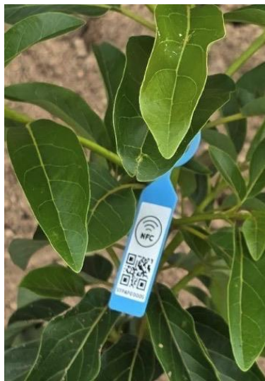
Gambar 5. Prototype Smart Tree Tagging pada Pohon Alpukat
