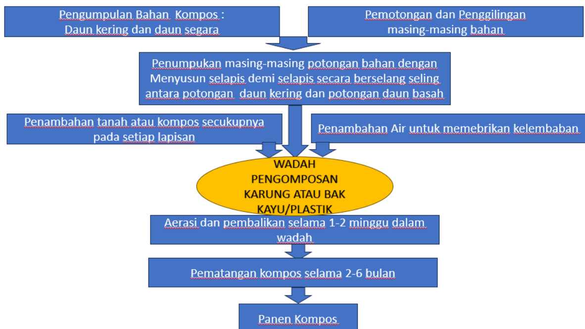
Gambar 1. Skema Tahapan Pembuatan Kompos dari Daun Kering dan Daun Basah
