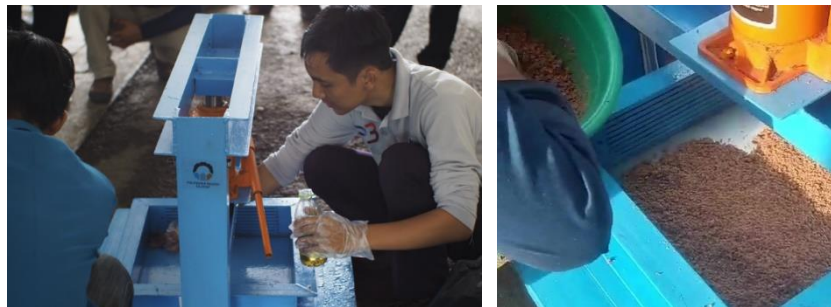
Gambar 4. Penuangan Adonan Secara Merata ke Dalam Cetakan
